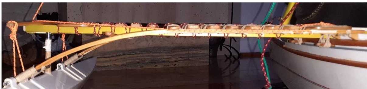
Rysunek 14. . Zdjęcie z boku aka modelu „Pjoa” Janusza Ostrowskiego w skali 1:5. W tym rzucie widać wygięcie czterech sprężyn płaskich oraz punkt podporu ama do dźwigarów.
